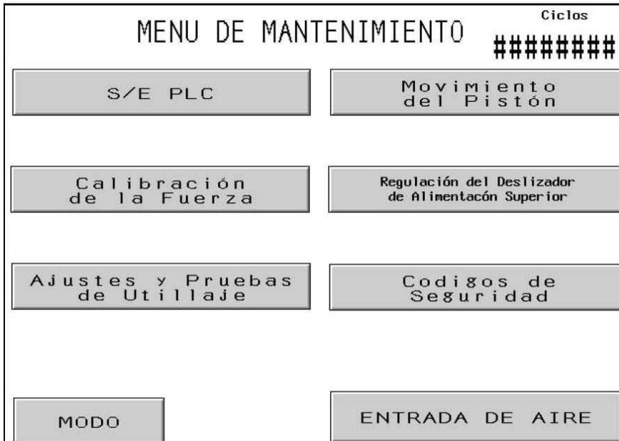
Esta pantalla permite que el operario tenga acceso a las funciones de mantenimiento. Aquí el operario puede acceder a ciertas pantallas de configuración, una pantalla de control de mantenimiento y los modos de prueba del utillaje para la alimentación automática.
